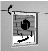
**Achtung:** Kurbel bei vollständig geöffnetem Rollladen nicht gewaltsam weiterdrehen. Kurbel bei vollständig geschlossenem Rollladen nicht weiter in Abwärtsrichtung drehen, sobald Sie einen Widerstand spüren
